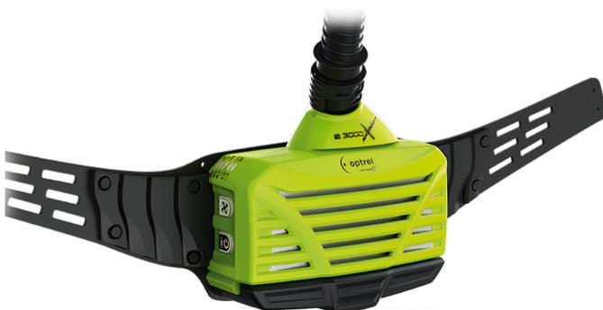
Respirador con ventilador de la clase de seguridad más alta (TH3) (Fuga hacia el interior máxima de 0.2% = eficiencia de filtración de 99.8%). Protege de forma fiable contra el humo, los aerosoles y el polvo. Disponible con filtro de gas A1B1E1. Posibilidad de filtros de carbón activado. Regulación y ajuste automáticos del caudal de aire.
