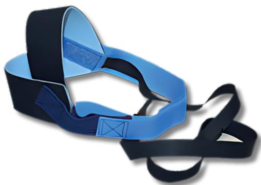
Implemento para la disipación electrostática, fabricado en goma antiestática (espesor: 2 mm), ajuste de gancho y felpa. Longitud del listón: 45 cm. Talla: unitalla. Nivel de resistencia: 106 +/- 10%. Nivel de abrasión: de 0.45 - 0.55 g. Elástico en la unión de la talonera, el cual sirve para un mejor ajuste al calzado. Colocación ambidiestra. Resistente, lavable y reusable.
