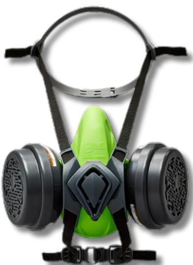
Semimáscara hecha en silicona o caucho termoplástico con 2 portafiltros de conexión bayoneta. Sistema de arnés de ajuste rápido. Cuerpo facial 25% más ligero, suave y cómodo. Fácil de desmontar y montar lo que facilita su limpieza y descontaminación. Disponible en dos tallas S/M y M/L.
