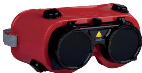
Monogafas de soldar con lentes transparentes y abatibles sombra 5. Clase óptica 1 y tratamientos antiempañante (N) -antiarañazos (clásica) - antirayos UV400. Ligera (157 g) y cómoda. Compatibilidad con orejeras y cascos de ciclista. Banda con cierre de clip en la parte trasera y elástico textil para facilitar su uso. Se pueden suministrar los lentes de repuesto 50 mm de diámetro en versión claros y sombras 5 al 8.
