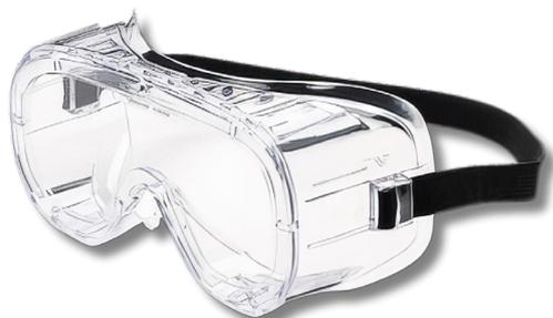
Monogafa de protección hecha con montura en PVC y lentes de policarbonato con tratamiento anti-empañamiento PLUS y antiarañazos. Con ventilación indirecta y cinta elástica ajustable. Clase óptica 1 y tratamiento UV380. Protección contra gotas y salpicaduras de líquidos (3); Protección contra las partículas a alta velocidad-media energía (B); Protección contra partículas de polvo de grandes dimensiones (>5micron) (4).
