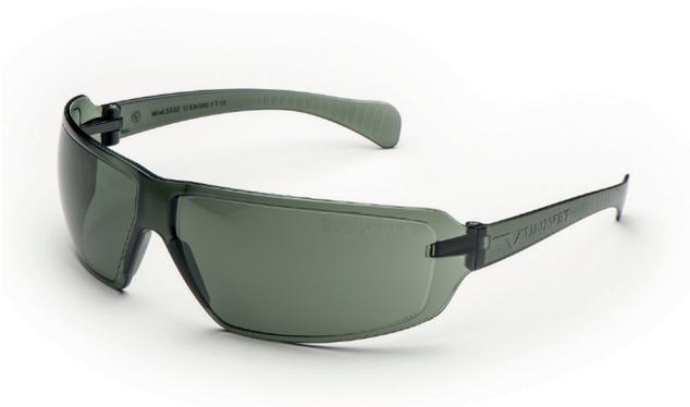
Espejuelos de protección de policarbonato ultraligeros (18 g), muy ergonómicos, lente envolvente que garantiza una protección lateral excelente. Patillas patentadas Zeronoise flexibles y compatibles con dispositivos de protección auditiva evitando que la orejera pierda su capacidad de atenuación. Lentes de clase óptica 1, resistentes a impactos de baja energía, con tratamientos antiarañazos (K), antiempañante.
