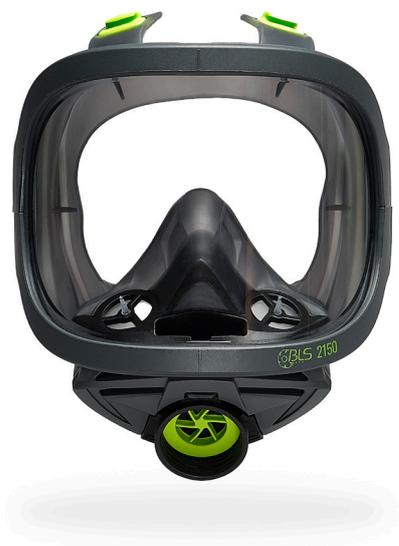
El sellado facial de las máscaras completas de la serie 2000 está fabricado en caucho termoplástico, al igual que el buco nasal interior, con el que está totalmente integrado, ofrecen un alto nivel de protección cuando se utilizan junto con los filtros de conexión universal EN 148 1 (serie BLS 400 o RD40), los cuales protegen contra gases/ vapores y partículas tóxicas. Disponible con diferentes visores: Policarbonato (modelo 2150) o Vidrio (modelo 2150V).
