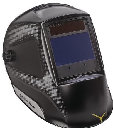
Pantalla de soldar optoelectrónica adecuada para todos los trabajos de soldadura con arco eléctrico (MIG, MAG, TIG y plasma, etc.). Tonos ajustables 9 a 13, baja intensidad de tono 5 a 9. Clase óptica 1 de rendimiento superior (menos fatiga visual).
