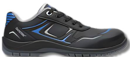
Calzado de seguridad hecho en piel micro-dry transpirable, hidrófuga, con puntera composite resistente a 200 J. Plantilla antiperforación textil (no metálica). Plantilla amovible: plantilla interior anatómica, transpirable, antiestática. Suela de PU 2D antideslizante SRC. Tallas 35 - 48.
