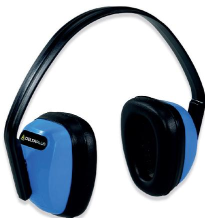
Orejeras anti-ruido de ABS con almohadillas de espuma PU de baja presión. Con arnés de cabeza. Altura regulable, posición izquierda/derecha. SNR 23 dB (H:24; M:20; L:14).
