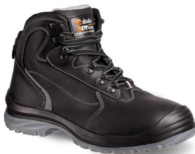
Bota de seguridad hecha en piel for repelente al agua, collar acochado y lengüeta en textil sintético. Forro 3D, transpirable y resistente a la abrasión. Puntera de composite resistente a choques hasta 200 J. Plantilla antiperforación resistente hasta 1100N hecha en Kevlar, altamente flexible y ligera. Plantilla removible PS03 antiestática y transpirable. Tallas 35 a 48.
