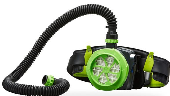
El respirador eléctrico 2600 es un equipo motorizado de ventilación para utilizarse con máscara completa y filtro antipolvo. El filtro antipolvo TMP3 suministra una filtración elevada durante largos periodos. Está protegido con un tapón contra agua, lo que facilita el proceso de limpieza y descontaminación del equipo. Garantiza el ajuste automático del flujo a 160 l/min, incluso cuando el filtro está obstruido.
