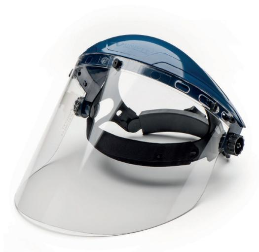
Pantalla de protección contra impactos (energético medio (B)), y contra partículas antiarañazos (K), ergonómica, hecha en policarbonato incoloro Clase óptica (1), con arnés de cabeza ajustable por sistema de rueda (53 a 64cm). Banda superior para la regulación de la altura del arnés. Abatible hasta 90 ° mediante sistema de fricción.
