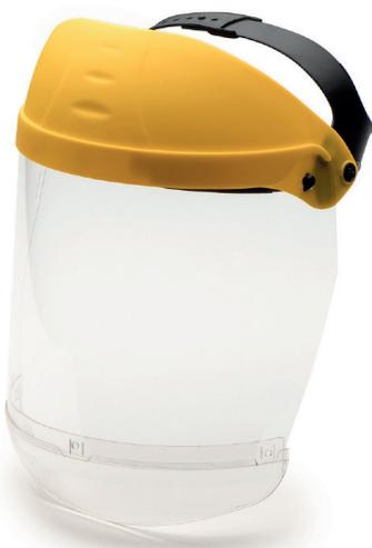
Pantalla en policarbonato de espesor 1mm abatible a 90 grados, clase óptica 1 con arnés de cabeza regulable mediante banda elástica. Puede ser llevada encima de las gafas y de dispositivos de protección de las vías respiratorias. Protector de barbilla de policarbonato reemplazable. Protección mecánica a impactos de media energía (B) y protección contra líquidos.
