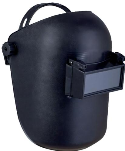
Pantalla de soldar equipada con un arnés de cabeza, ventana abatible sombra 11. Cristales diámetro 108 x 51mm. Protege contra calor, golpes y rayos UV/IR. Clase óptica 1. Gran resistencia mecánica en pantalla y lentes.
