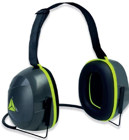
Orejas anti-ruido de ABS con arnés de cuello, a nivel de la nuca, y banda textil de sujeción para ajuste y talla. Permite el uso con cascos de protección de manera combinada. Almohadillas de espuma PU durables y reemplazables. Libre de PVC. SNR 28 dB (H:33; M:26; L:15).
